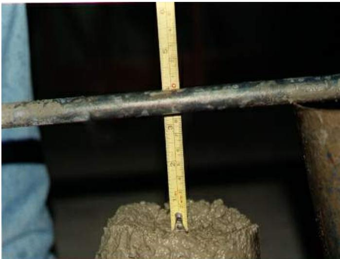
Con la llegada a obra del hormigón fresco se procederá a realizar el ensayo de consistencia del hormigón mediante el cono de Abrams. Este permite medir el asiento del hormigón y es la única herramienta de que dispone la dirección de obra para rechazar un hormigón. Por lo general en edificación el asiento no será inferior de 6 cm., y nunca mayor de 15 cm.
