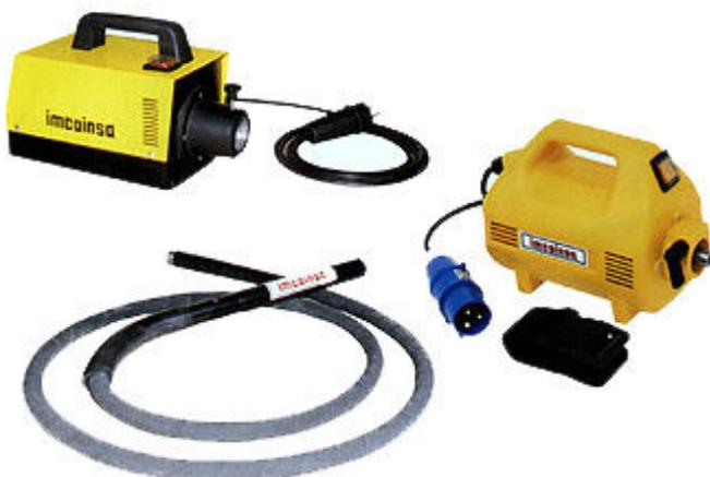
En el mercado existen muchos tipos de vibradores, de diversos tamaños y frecuencias. Por lo general para los hormigones estructurales normales se suelen emplear frecuencias de unos 6000 Hz. La amplitud y la potencia dependerán del volumen del elemento a vibrar; los de aguja de pequeña potencia van bien en pilares, vigas, forjados, etc.
