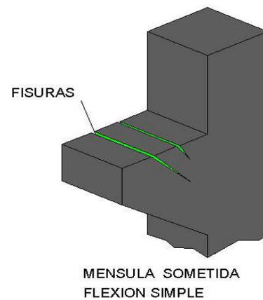
En los croquis superiores se observa la fisuración por flexión de una viga y una ménsula, las principales características de este tipo de fisuración se puede resumir en:
