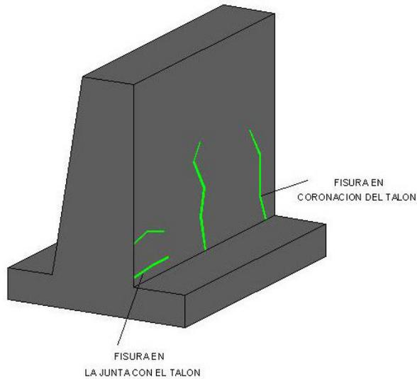
En los muros de gran espesor, las fisuras causadas por la contracción térmica aparecen como en el croquis. Este tipo de fisuras se producen debido al gradiente de temperatura que existe entre el interior de la masa y la parte trasera del muro en contacto con el terreno.
