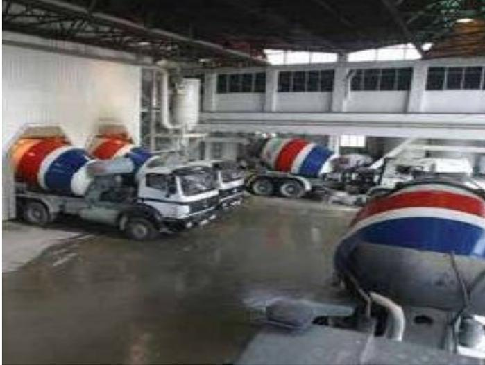
En la actualidad todas las centrales de hormigón cuentan con silos y naves independientes para almacenamiento. En la dosificación y la mezcla se emplean máquinas muy precisas y totalmente informatizadas para evitar cualquier error en la fabricación. Cuando el hormigón fresco está listo lo introducen en los tambores de los camiones y lo transportan a la obra.
