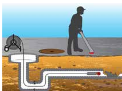
Mostra de inspeção por vídeo em condutas.
